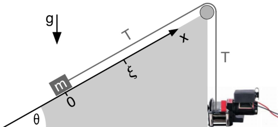
Nell'intervallo di tempo fra  $t=0$  a  $t=\tau$  un blocchetto di massa  $m$ , soggetto alla forza peso  $m\vec{g}$  e a quella di un motore elettrico  $f(t)$  cui è collegato con un cavo di trazione (vedi figura), risale un piano liscio, inclinato di un angolo  $0 < \theta < \pi/2$  con il piano orizzontale, con legge oraria
